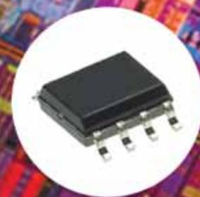
Микросхема ILA82C251D – интерфейс между CAN-контроллером и физической шиной – обеспечивает дифференциальную передачу данных в шину и дифференциальный прием на контроллер CAN. Микросхема определяет скорость, дальность и помехоустойчивость передачи данных, количество узлов в сети, уровень электромагнитных излучений и другие параметры.
