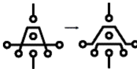
Рис. 1. Устранение двойного пересечения проводников
