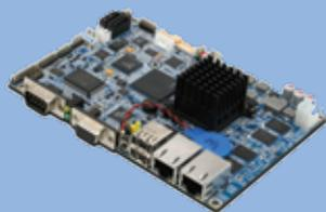
Компания Avalue, один из крупнейших производителей промышленных компьютеров и встраиваемых систем, выпустила первый компактный одноплатный компьютер модели ECM-QB форм-фактора 3,5"
