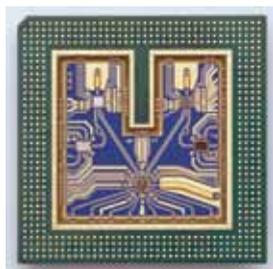
**Рис.4. Микросборка аналогового входного модуля осциллографов Infiniium 90000 X-серии**
