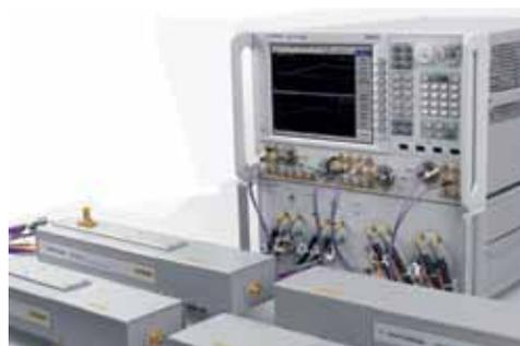
**Рис. 1. Тестовая система в составе векторного анализатора цепей PNA-X N5247A, тестового 4-портового контроллера миллиметрового диапазона и с четырьмя частотными расширителями (смесителями)**
