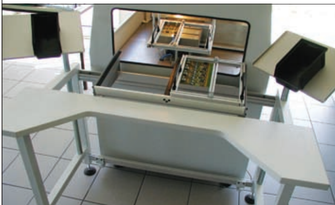
Рис.2. Загрузка паллеты в установку
