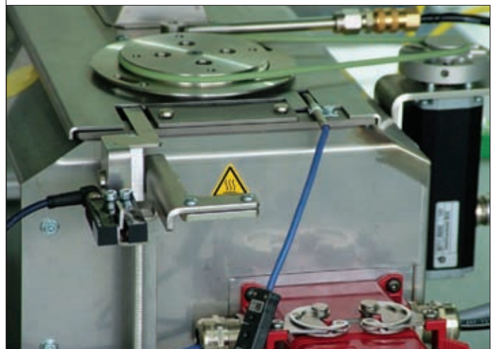
Рис.5. Расположение помпы нагнетания волны припоя нового образца
