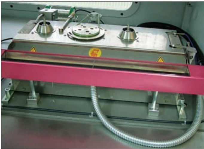
Рис.6. Расположение двух паяльных насадок, установленных в ванне припоя
