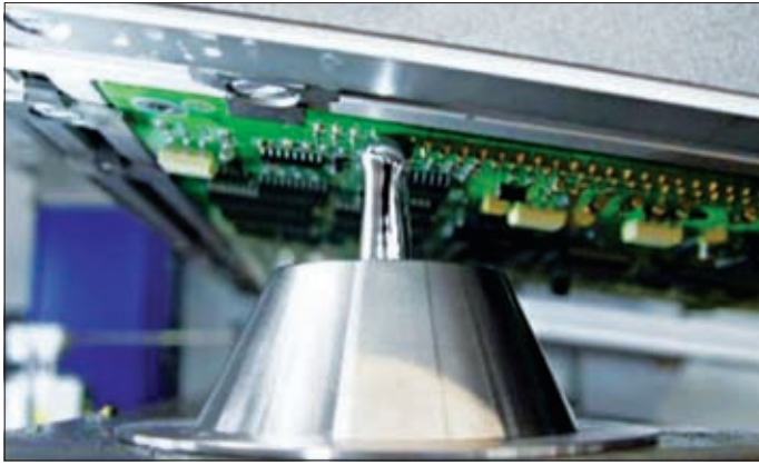
Рис.3. Модуль пайки установки SPA
