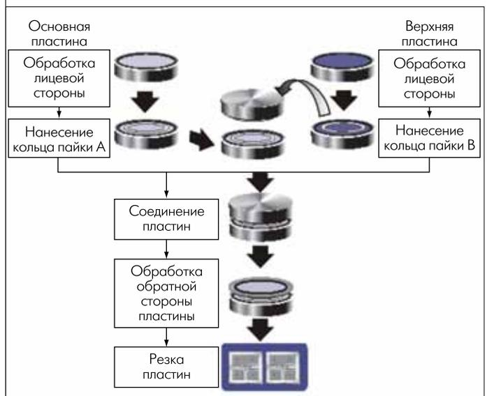
**Рис.2. Последовательность операций процесса корпусирования СВЧ МИС на пластине**
