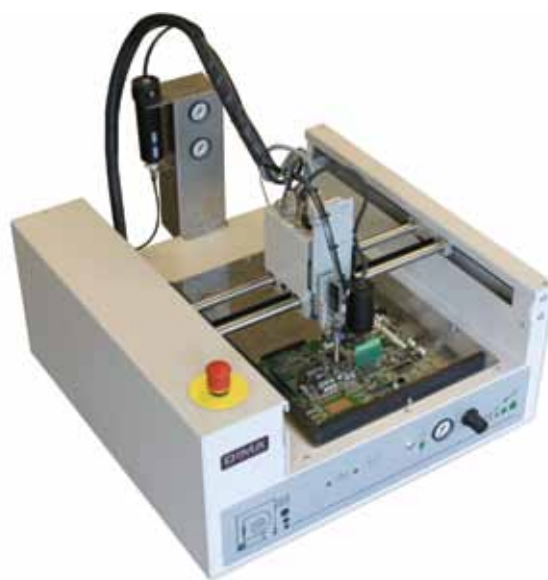
Рис. 2. Полуавтоматический дозатор для нанесения защитных покрытий DD-500 (Dima)
