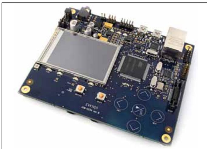
**Рис.3. Набор для проектирования ATEVK1105 для МК AVR32UC3A1**
