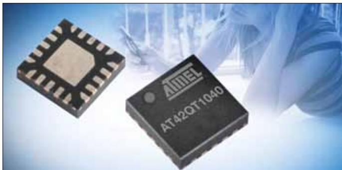
**Рис.5. Контроллер сенсорной клавиатуры AT42QT1040**
