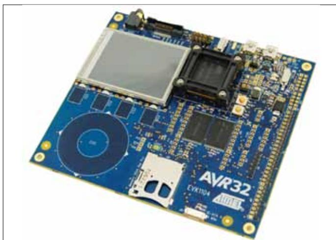
**Рис.2. Набор для проектирования ATEVK1104 для МК AVR32UC3A3**
