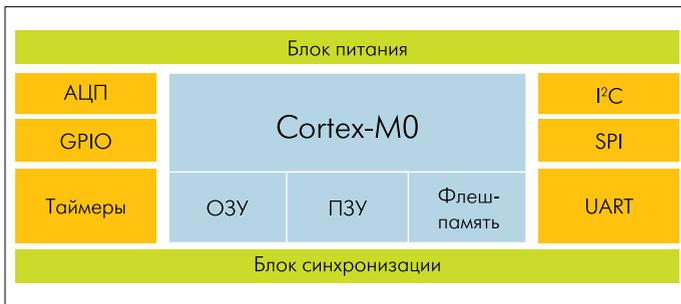
Рис.3. Блок-схема микроконтроллера LPC 1100
