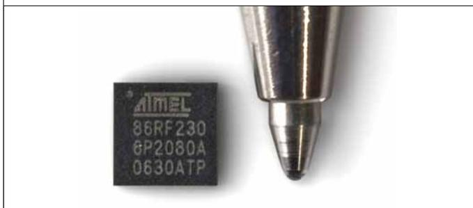
**Рис.4. AT86RF230 в компактном корпусе QFN32 размером 5x5 мм**
