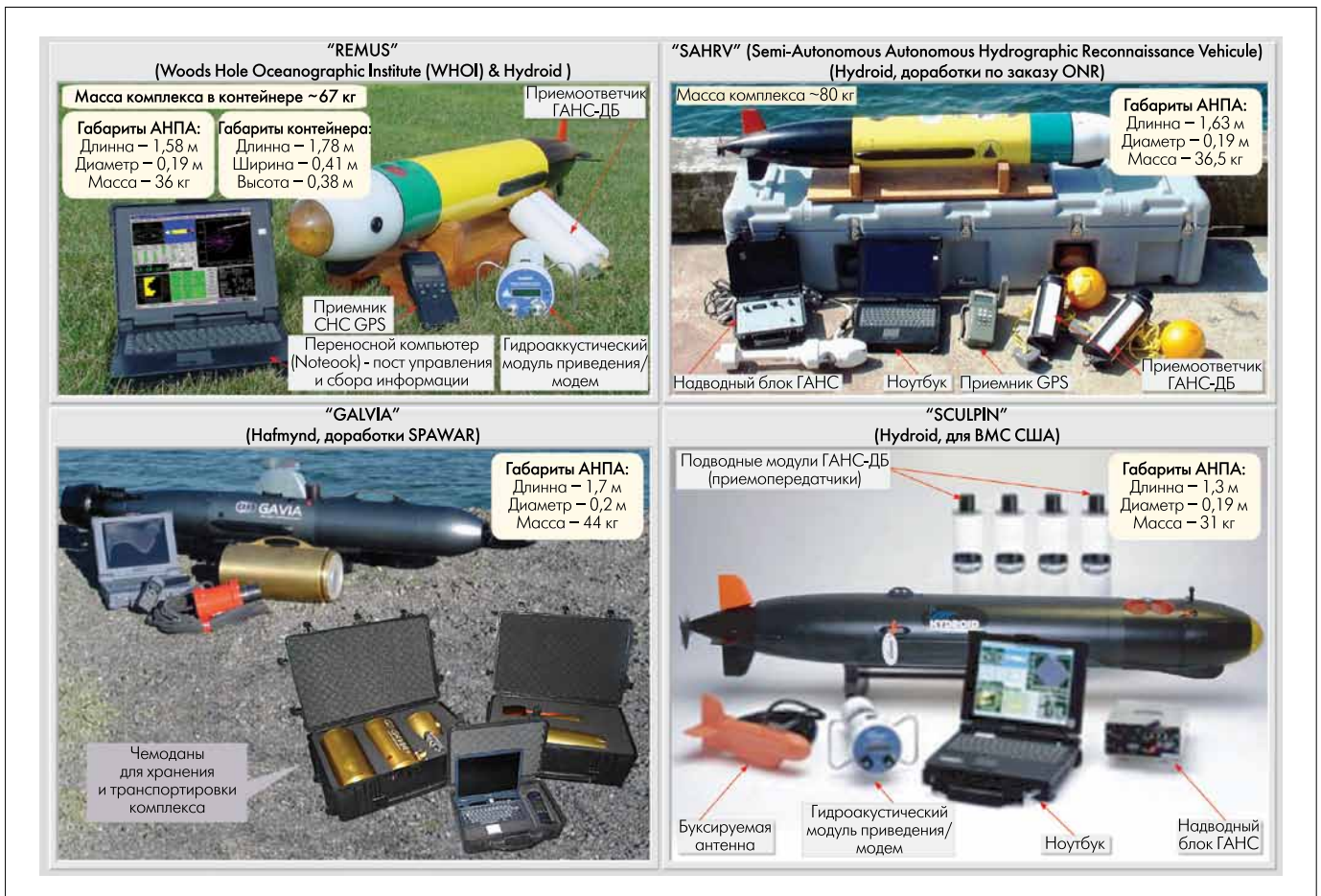
Рис. 15. Малогабаритные переносные комплексы АНПА с базовой стоимостью 250–350 тыс. долл.
