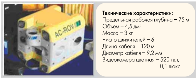
Рис.8. ПМА "AC-ROV SP50", предназначен для проведения обзорных работ
