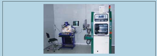
Установка монтажа кристаллов PP-5 компании CEFORI (Франция), размещенная в чистой комнате ООО "Совтест АТЕ"
