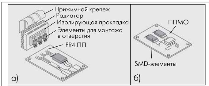
**Рис.3. Упрощение конструкции устройств при применении ППМО:**
