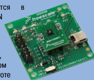
В качестве отладочного комплекта компания Freescale рекомендует стартовый набор – RD3803MMA7660, в состав которого входят две платы – KIT3803MMA7660FC и интерфейсная плата, позволяющая подключиться к компьютеру по USB-интерфейсу, а также CD-диск с необходимым программным обеспечением. Плату KIT3803MMA7660FC, которая устанавливается в стандартный DIP-разъем, можно заказать отдельно.
