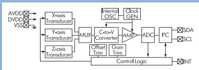
Акселерометр выпускается в 10-выводном корпусе типа DFN размером  $3 \times 3 \times 0,9$  мм. Его диапазон рабочих температур составляет  $-40 \dots 85^\circ\text{C}$ . Напряжение питания – 3,6 В. Ток, потребляемый акселерометром в активном режиме, при частоте измерений 1 Гц составляет 47 мкА, в спящем – всего 2 мкА.
