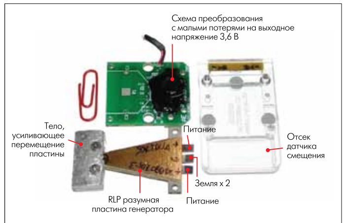
Рис.6. RLP-микрогенератор напряжения модуля Joule-Thief
