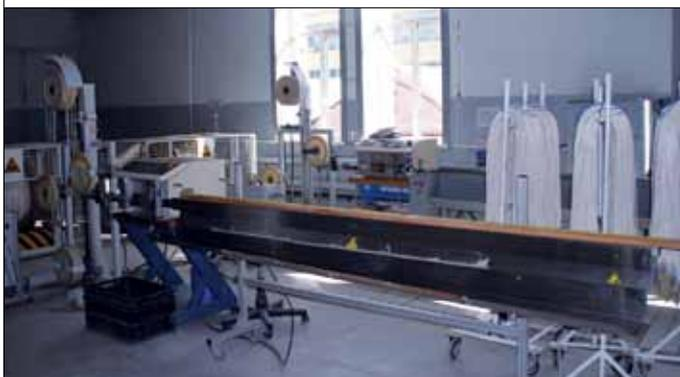
Станция мерной резки и снятия изоляции провода на базе оборудования фирмы Schleuniger
