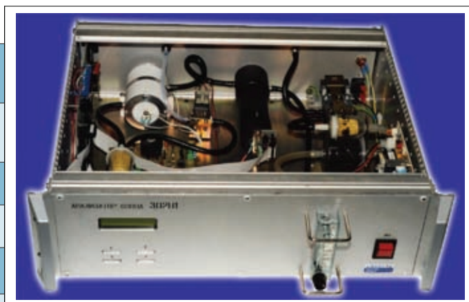
Рис.3. Газоанализатор для атмосферного мониторинга со снятой крышкой
