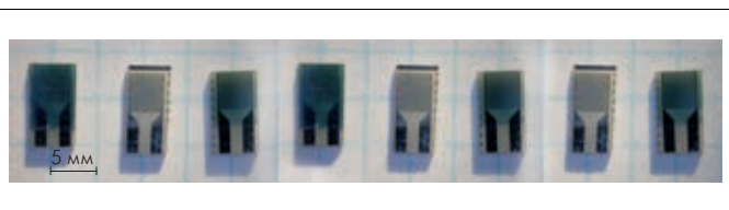
Рис.5. Массив из восьми чувствительных элементов
