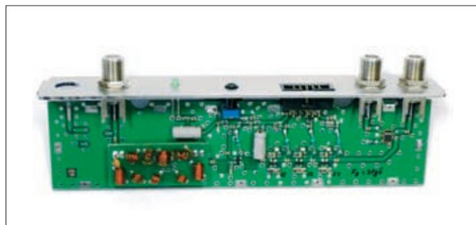
**Рис.11. Плата с установленной передней панелью**
