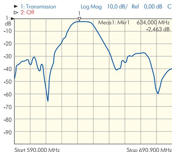
**Рис.8. Характеристика ПАВ-фильтра 41-го эфирного ТВ-канала (г. Подольск)**
