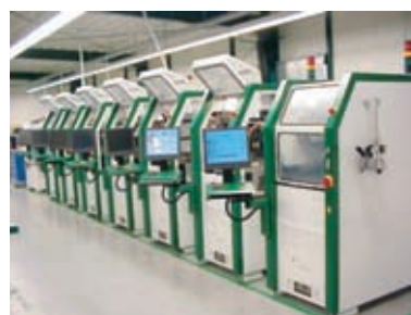
Рис. 12. Пример автоматизированной линии, состоящей из семи установок VJ920
