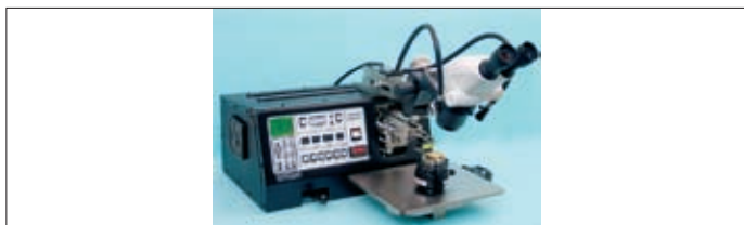
Рис. 10. Универсальная полуавтоматическая установка микросварки. Модель Hybond 626
