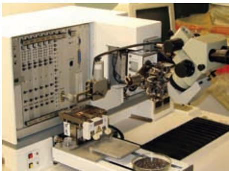
**Рис.4. Установка присоединения кристаллов ЭМ-4025АМ**
