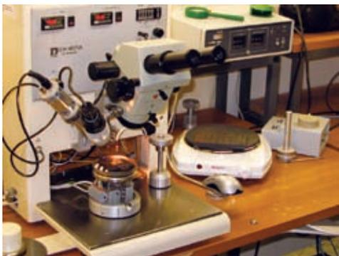
**Рис.3. Установка присоединения кристаллов ЭМ-4075А**
