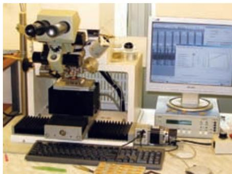
**Рис.6. Установка для монтажа проволочных выводов ЭМ-4370**
