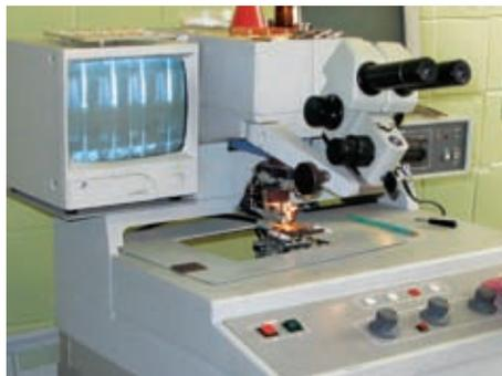
**Рис.5. Установка для монтажа проволочных выводов ЭМ-4480**
