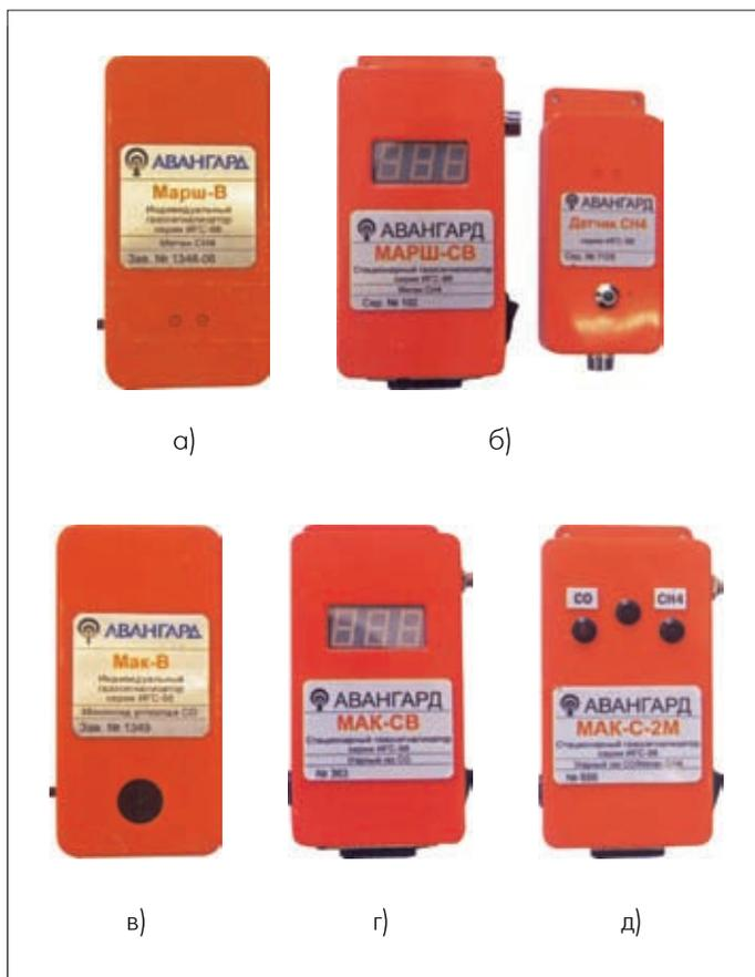
Рис. 1. Электронные газосигнализаторы: а – МАРШ-В, б – МАРШ-СВ, в – МАК-В, г – МАК-СВ, д – МАК-С-2М
