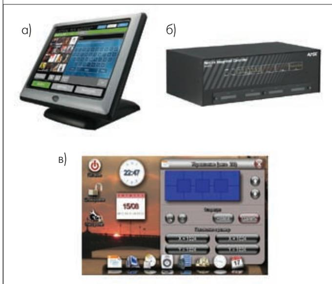
**Рис.3. Программно-аппаратный комплекс управления видео-стенной: а: сенсорная панель АМХ NXT-15000; б: контроллер управления АМХ NI-4100; в: вид экрана оператора в режиме настройки сценариев видеостены**
