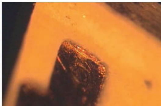
**Рис. 2. Микросечение контактной площадки платы AdvancedMC – обнажившаяся медь подвержена коррозии**
