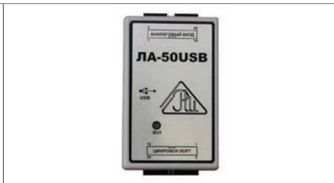
Рис.4. Преобразователь аналоговых сигналов ЛА-50USB
