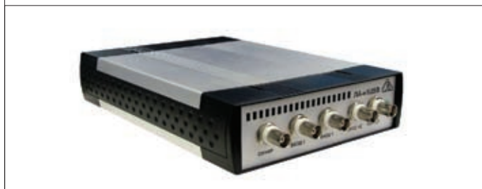
Рис.5. Высокочастотный преобразователь аналоговых сигналов ЛА-н1USB
