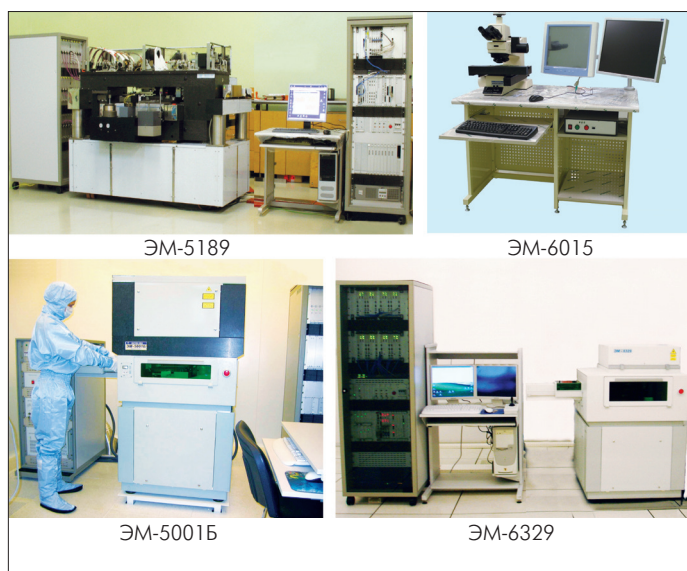
Рис. 1. Комплекс оборудования для бездефектного производства фотошаблонов
