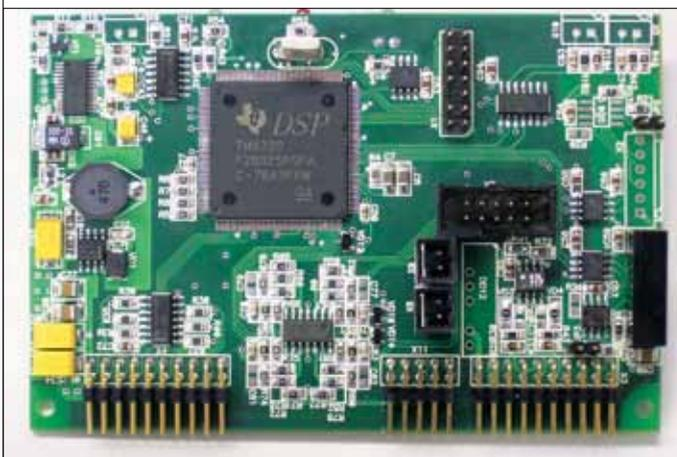
**Рис.3. Специализированный контроллер МК20.1 на базе TMS320F28335 для преобразователей частоты мощностью до 7,5 кВт**
