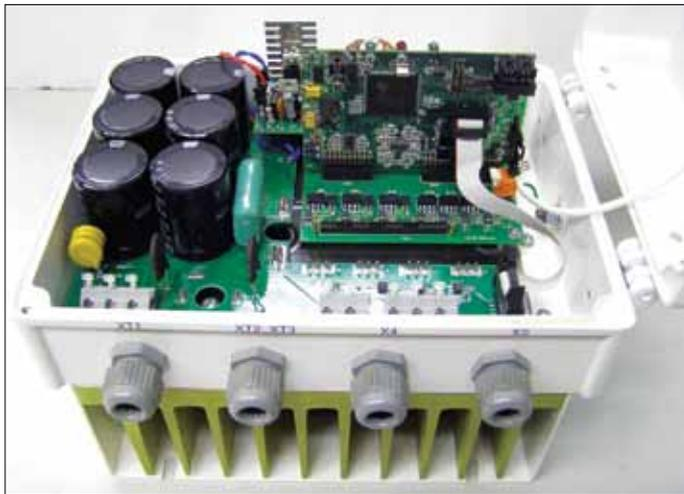
**Рис.4. Преобразователь частоты мощностью до 3,7 кВт с высокопроизводительным контроллером МК20.1**
