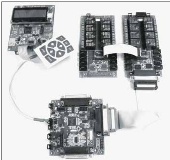
**Рис. 1. Система управления ПЧ на базе контроллера МК10.5 с модулями ввода-вывода и пультом оперативного управления**
