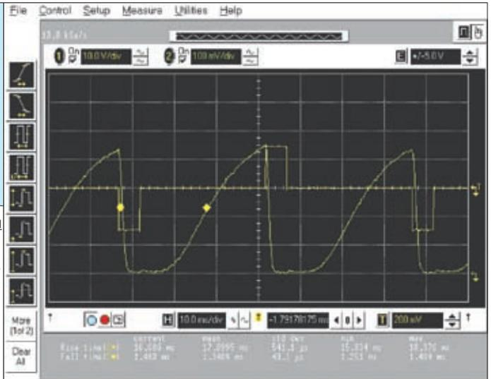
**Рис.8. Оптический отклик прототипа пассивно-матричного дисплея трехэлектродной конструкции на горизонтально-вертикальное переключение электрического поля**
