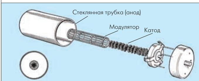
**Рис.6. Аксиальный источник света триодной конструкции**
