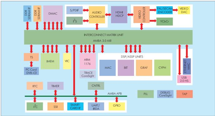
**Рис.3. Структура системы на кристалле для HDTV**
