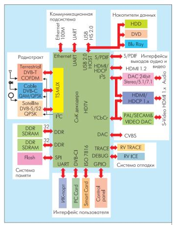
Рис.2. Схема устройства приема ЦТВ
