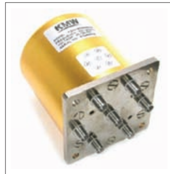
Рис.3. Переключатель KSW100NAE002 SP6T-типа (0–20 ГГц; IL = 0,2 дБ; Iso = 80 дБ; τ = 10 нс)
