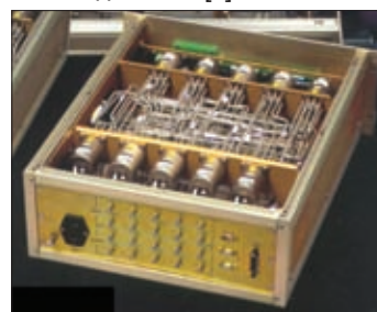
Рис.6. Коммутируемая коаксиальная матрица серии 4402 фирмы Dow-Key Microwave
