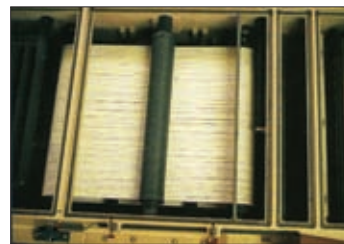
Рис.4. Система транспортировки заготовок жестких, гибко-жестких и гибких печатных плат
