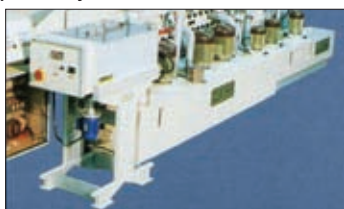
Рис.3. Модуль автоматического пополнения пемзового порошка
