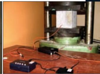
**Рис.6. Волоконно-оптический датчик внутри бетонного образца**
