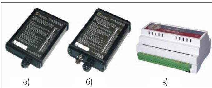
**На рисунке приведены: а) регистратор навигационных данных, дискретных и аналоговых сигналов, б) абонентский GSM/GPRS терминал с встроенным регистратором навигационных данных, в) абонентский GSM/GPRS терминал с встроенным регистратором данных потребления электроэнергии**
