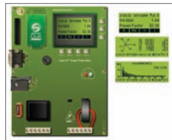
Рис.3. Электросчетчик на базе процессора Wavocom с передачей данных по GSM-каналу
