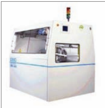
Рис.4. Автомат селективной пайки SPA-250/400
