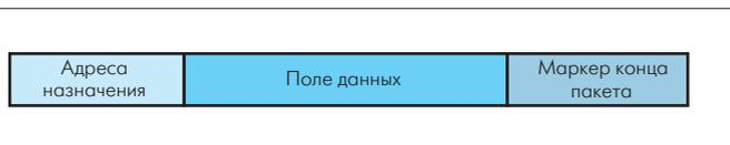
Рис.4. Формат пакета SpaceWire
