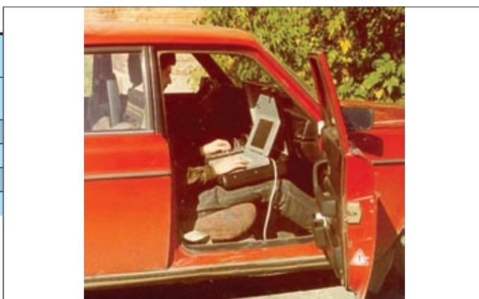
Рис.3. Прибор экспресс-контроля технического состояния тормозных систем автотранспортных средств в дорожных условиях
