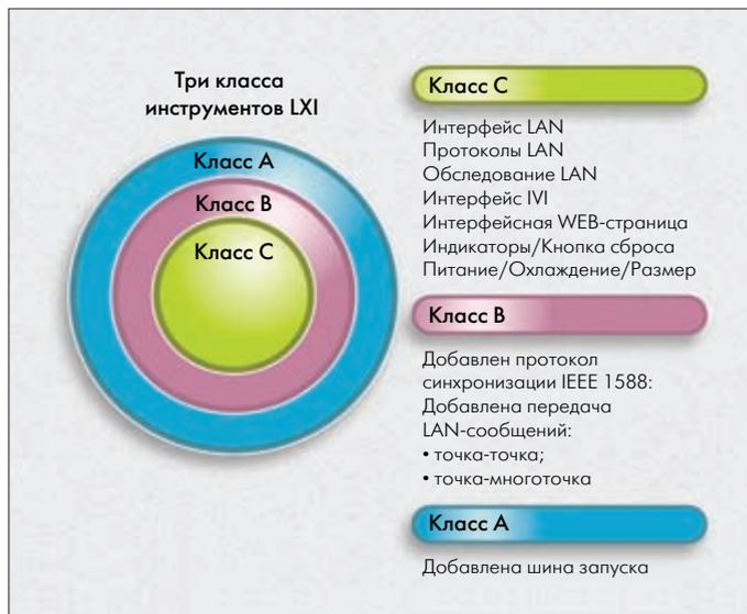
**Рис. 2. Три класса инструментов LXI**
