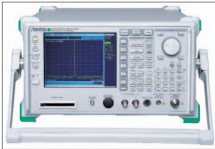
**Рис.6. Анализатор спектра Anritsu MS 2687B**
