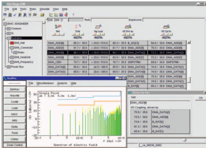
Рис.3. Анализ спектра излучаемых помех в модуле Hot-Stage EMI
