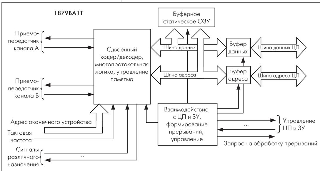
**Функциональная схема БИС 1879ВА1Т**
