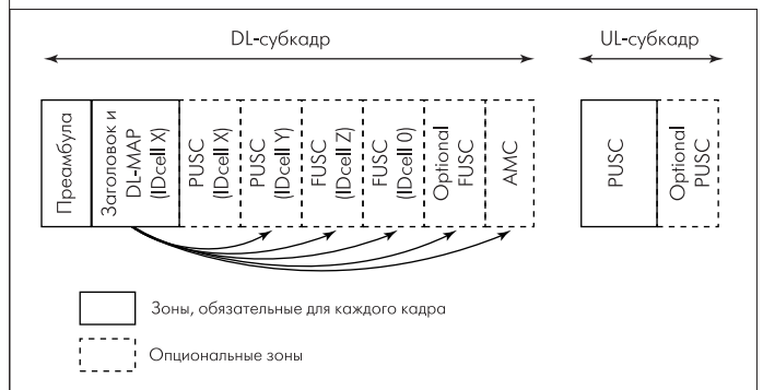
Рис.2. Совмещение различных "зон перестановки" в OFDMA-кадре
