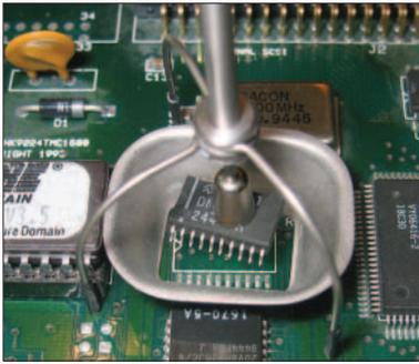
**Рис.4. Процесс демонтажа SOIC20**
