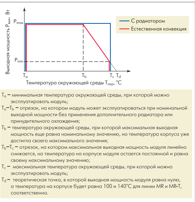
Рис.6. Типовая кривая снижения выходной мощности модуля в зависимости от окружающей температуры
