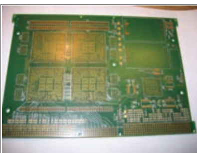
20-слойная МПП производства ИТМ и ВТ
