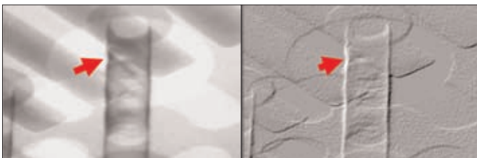
Рис.7. Разрушение металлизации переходных отверстий ПП в процессе оплавления
