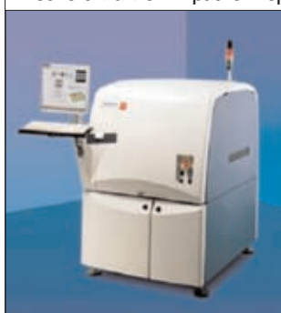
Рис.4. Новая система 2D/3D-контроля Symbion P36
