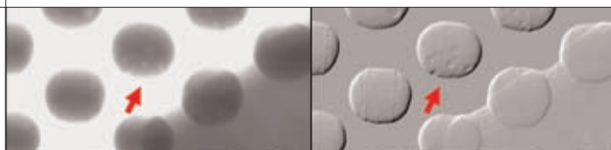
Рис. 12. Иллюстрации механизма образования микротрещин, связанных с короблением ПП и подложек ИС в процессе оплавления
