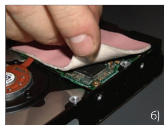
Рис.4. Применение материала Gap Pad VO (а) и Gap Pad VO Soft (б)
