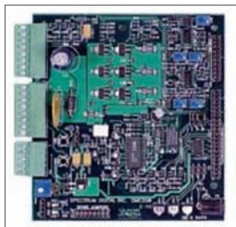
**Рис.7. Плата контроллера электродвигателя DMC550**
